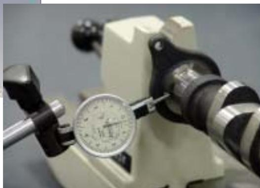
DuraMax visualizza in modo veloce e automatico la precisa deviazione di forma. La stessa operazione eseguita con uno strumento da banco (comparatore) non fornisce le stesse informazioni.
