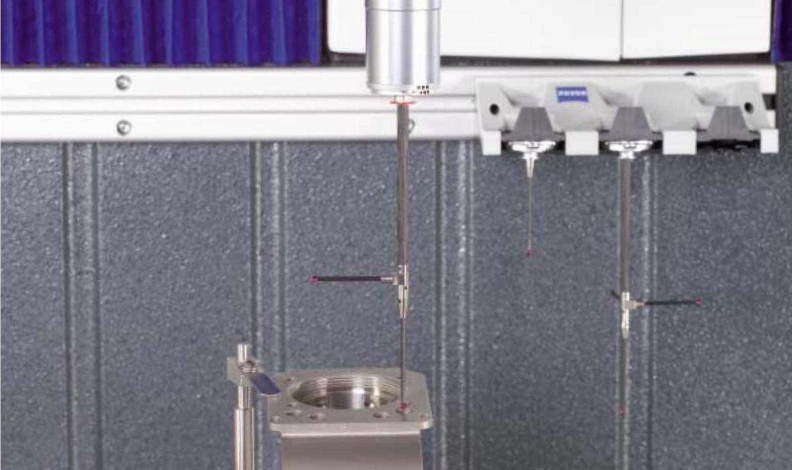
La scansione consente il controllo statistico del processo DuraMax può essere posizionata accanto alla macchina utensile per controllare il processo di produzione in corso. I risultati di misura seguono il percorso più breve e rapido per ritornare alla macchina utensile.
