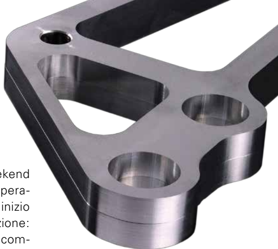
L'errore di 70 \mu m risultante dal riscaldamento della vite a ricircolo di sfere è chiaramente visibile con la doppia lavorazione
