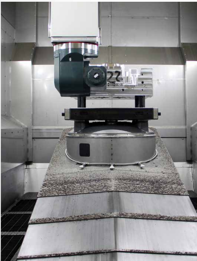
Flessibilità: la tavola inclinata consente di forare e fresare su 5 assi e su 5 superfici.
