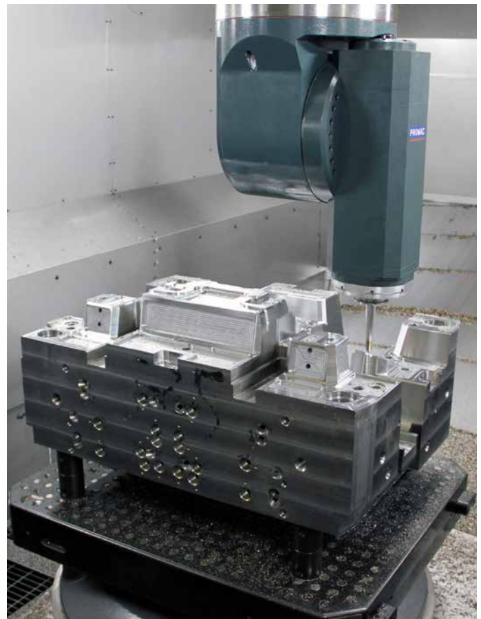
Adattabilità: il sistema di cambio testa consente di eseguire qualsiasi lavorazione sulla macchina.
