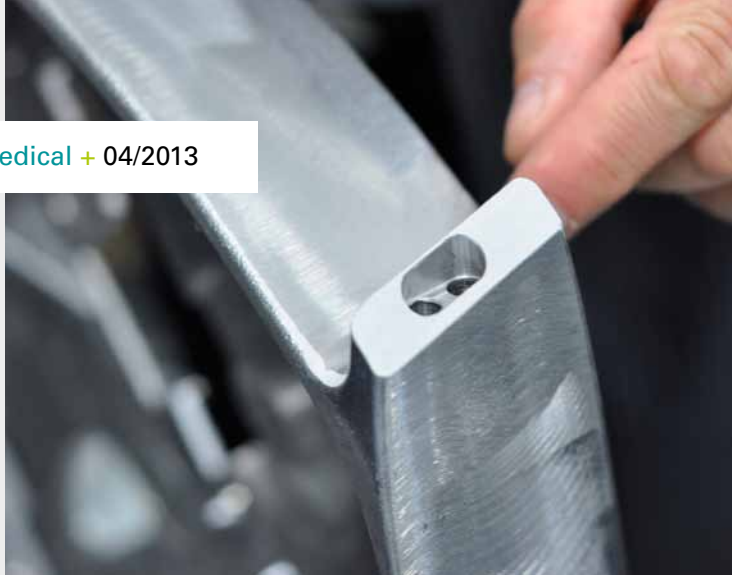
Le strutture dalle pareti sottili richiedono elevata accuratezza nella lavorazione.
