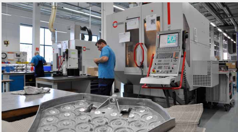
Il pezzo pressofuso viene lavorato in un solo serraggio.
