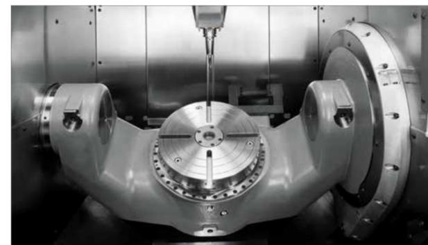
La tavola roto-basculante CN „Torque“ – l'ideale per la tecnologia a 5 assi.
