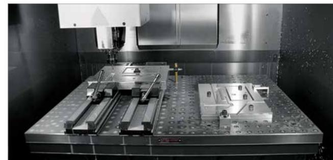
L'ampia zona di lavoro del centro di lavorazione C 40 V con asse X - 850 mm, Y - 700 mm e Z - 500 mm e tavola portapezzo rigida con una superficie di serraggio di 1.070 x 700 mm; la tavola può essere sfruttata in modo universale con dispositivi di serraggio standard e speciali; la struttura slanciata dell'asse Z e il mandrino portafresa garantiscono un'ottima accessibilità per la lavorazione di superfici a 5 lati.
