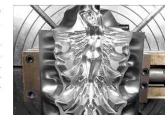
Ulteriore stampo in ghisa speciale per costruzione di forme per la fusione di una esclusiva scultura in cristallo.
