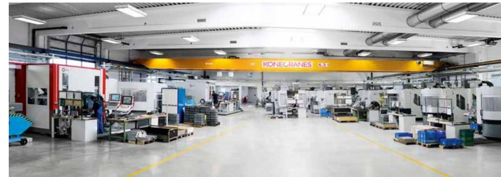
Destra: il "parco Hermle" nel centro produttivo di 6.500 m2 di Höcherl & Reisinger a Walderbach (Baviera), tra cui il sistema di produzione flessibile (FMS), composto da due centri di lavorazione CNC ad alte prestazioni a 5 assi C 42 U e il sistema robotizzato RS3 con magazzino utensili.
