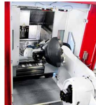
A sinistra: robot mentre movimentava un pallet portapezzi; il robot preleva un pallet dall'apposito scaffale e lo appoggia sulla tavola della macchina predisposta; in precedenza il robot estrae il pallet con il pezzo finito e lo deposita nel magazzino; inoltre il robot è preposto alla movimentazione dei pallet sul posto di attrezzaggio.
