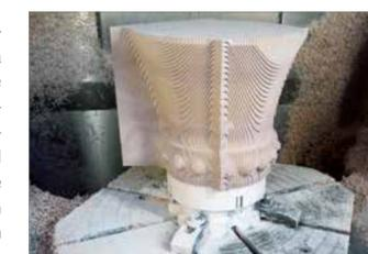
Zona di lavoro del centro di lavorazione Hermle C 30 U con tavola roto-basculante CN (Ø 630 mm) per la lavorazione completa a 5 assi di prototipi complessi, modelli e segmenti di stampi nella formatura in 3D.
