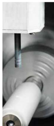
Produzione di un albero con canale di raffreddamento in 1.2344 (acciaio per lavorazione a caldo temprabile, H13).
